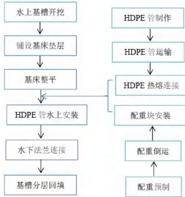
图 2.4.1-4 海上取水管线施工流程图
