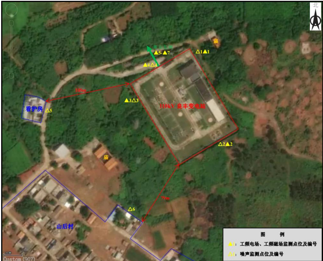
图 1 110kV 良丰变电站监测布置图
