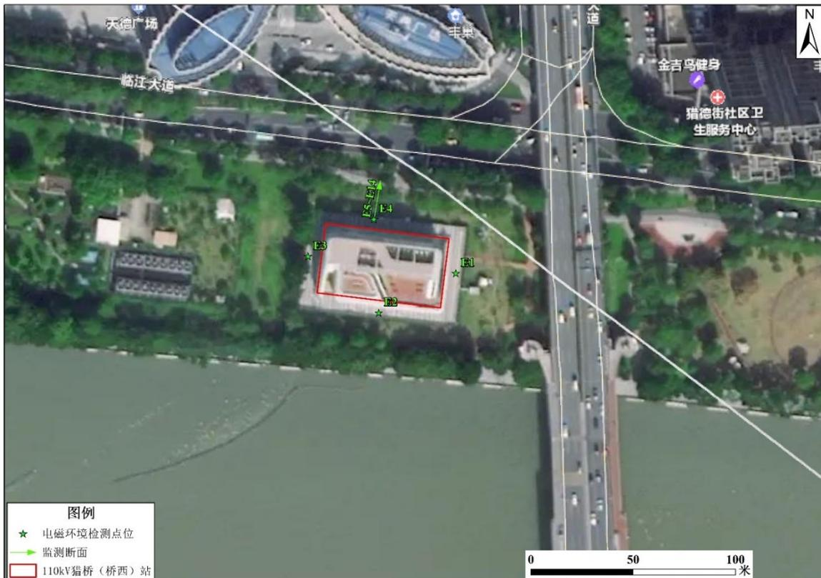
图 8.1-3 广州 110kV 猎桥（桥西）站监测布点图
