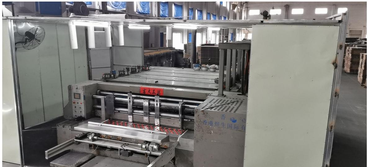
图6-5 印刷机密闭措施
