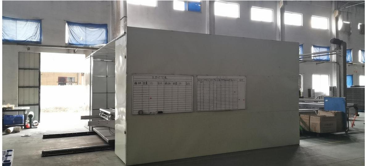
图6-6 印刷机密闭措施
